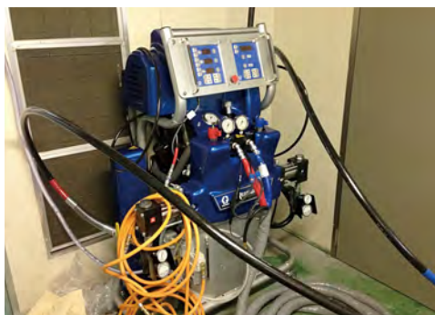
混合装置：リアクター H-40 (グラコ社製) スプレーガン：P2ガン(グラコ社製)
