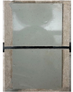
▲市販高伸長形ウレタンゴム系 塗膜防水材 密着工法 3mm厚さ (評価:区分3)
