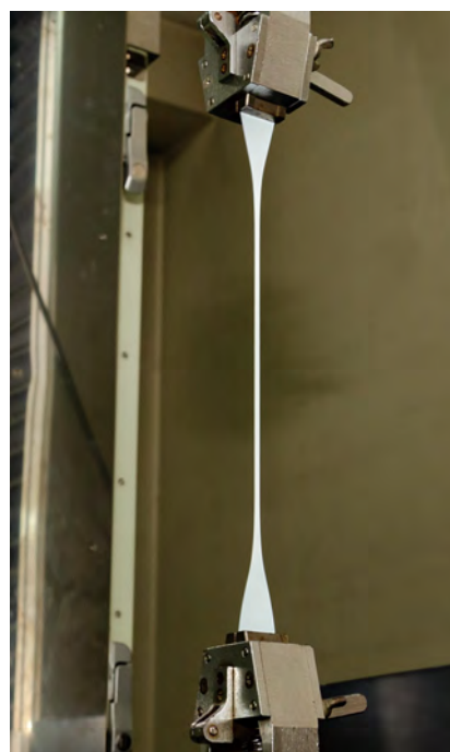
▲破断時のつかみ間の伸び率の試験におけるハイブルーフの伸び率。23℃で464%の弾力性。
