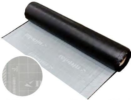
ガラス補強布、改質アスファルトの積層シートです。表面にはウレタン防水材と相性のよい特殊加工が施され、水のしみ込みリスクを低減します(突き付けタイプ厚さ1.5mm×幅1m×長さ15mは受注生産となります)。
