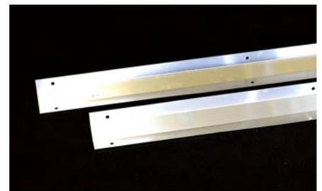
耐食アルミ製でPK工法(機械的固定工法)・PKD工法(機械的固定・断熱・遮熱工法)入隅コーナー用です。(10穴/本)
