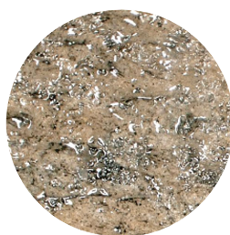
▲固着シーラー塗装部 (30倍拡大)
